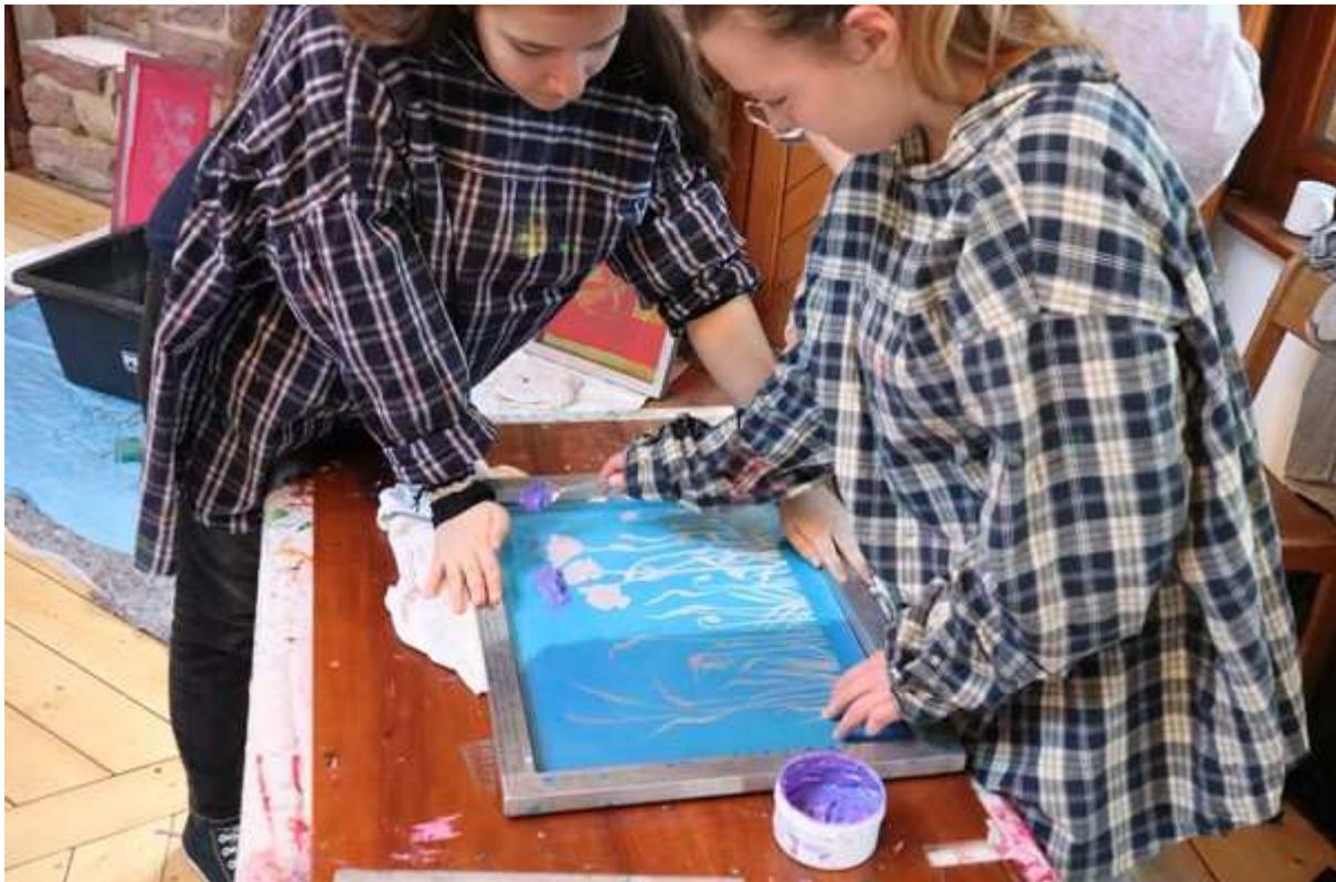
Abbildung 1 Textilfarbe wird auf das Sieb aufgetragen...
